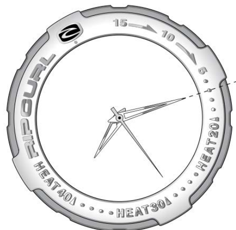
Bezel mengindikasikan tiga menit lagi untuk mencapai 20 menit Heat
