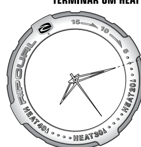
ANEL GIRATÓRIO INDICANDO QUE FALTAM TRÊS MINUTOS PARA TERMINAR UM HEAT DE 20 MIN
