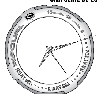
ARO ROTATIVO INDICANDO 3 MINUTOS RESTANTES EN UNA SERIE DE 20 MINUTOS
